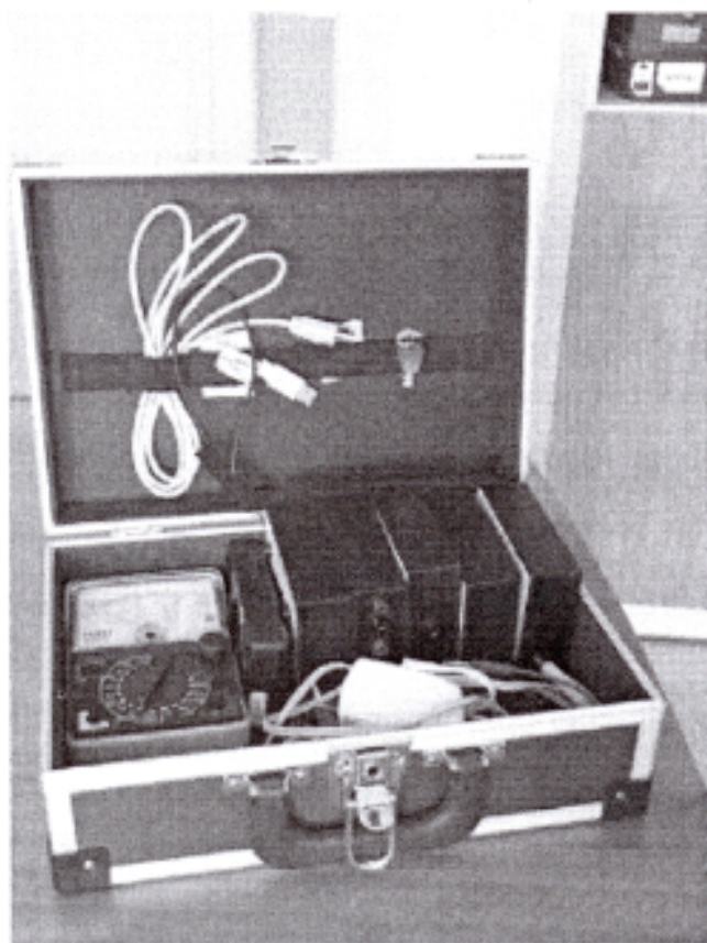
Joonis 4. Mobiilse laborikohvri HomeLabKit teine versioon. Mobiilne laborikohver peab olema mehaaniliselt tugev ning paindliku ja robustse sisuga
